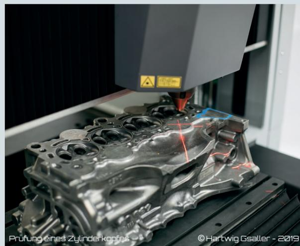
Prüfung eines Zylinderkopfes © Hartwig Gsaller - 2019
